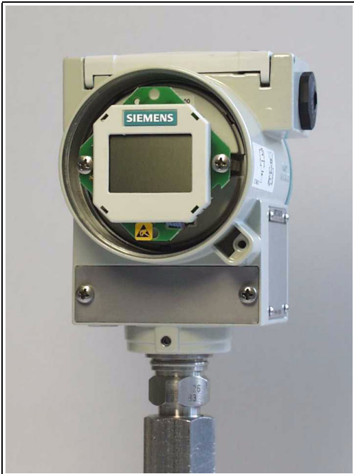
Bild 6 Gerät mit abgeschraubtem Deckel
