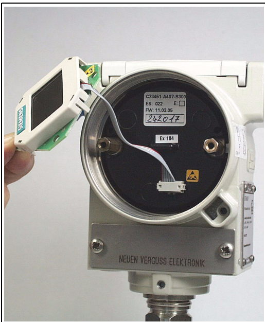
Bild 8 Abziehen der LCD-Anzeige ab Erzeugnisstand 30
