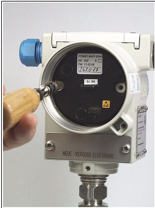
Bild 22 Anschrauben der Gewindebolzen, die die Elektronik fixieren
