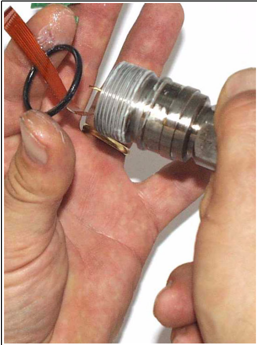
Bild 30 O-Ring auf Messzelle aufstecken
