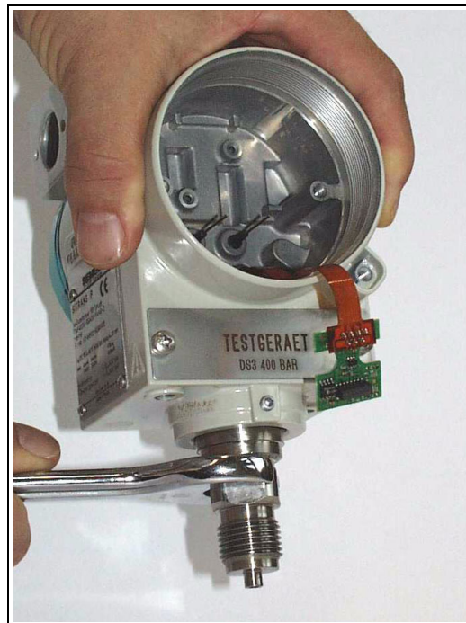
Bild 29 Zelle mit Gabelschlüssel lösen
