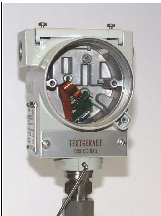
Bild 28 Lösen der Arretierschraube mit Imbusschlüssel
