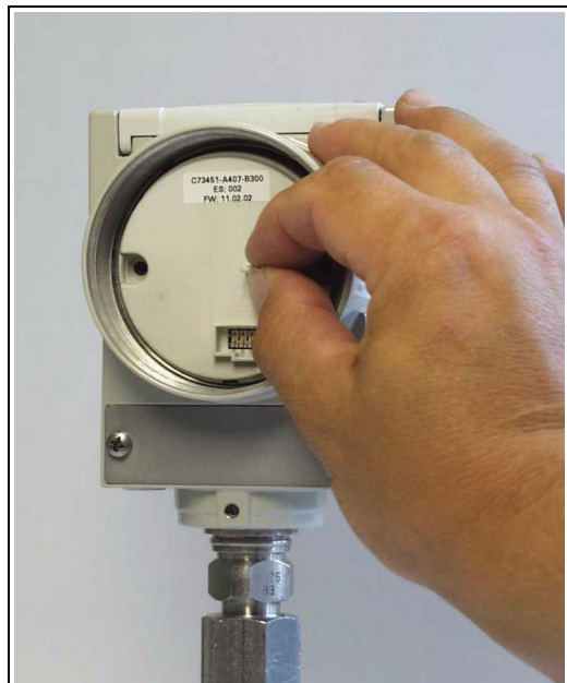
Bild 9 Herausziehen der Elektronik
