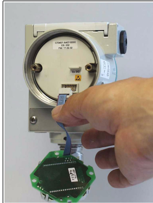
Bild 7 Abziehen der LCD-Anzeige bis Erzeugnisstand 29
